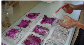
Nettoyer et asperger avec phénolphthaléine (ou thymolphthaléine)
